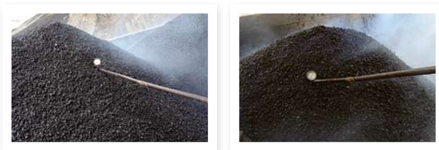
Figura 2. À esquerda GAP GRADED usinado ECOFLEXPAVE B a 178°C. À direita GAP GRADED usinado com ECOFLEXPAVE B-3G a 160°C.
