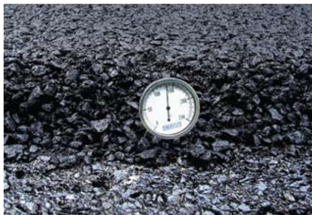
Temperatura de compactação de mistura tipo GAP Graded com ECOFLEXPAVE B-3G – 138C.
