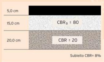
Figura 2 - Estrutura dimensionada pela metodologia do DNER/81.
