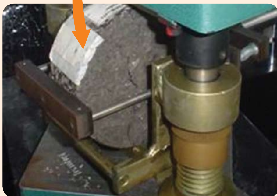
Figura 1 - Equipamento de compressão diametral da UFSC utilizado para avaliação do módulo resiliente e estudos de fadiga de misturas asfálticas.
